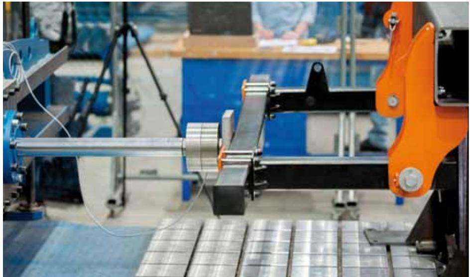
Die Untersuchung des hinteren Balkens einer Siebtrommelmaschine
