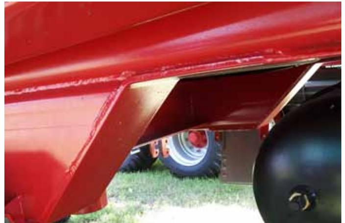
Die Kipp - Brücke wird aus rechteckigen hochqualitativen geschlossenen Stahlprofilen geschweißt
