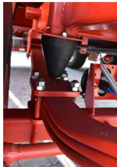
Die Parabelfederung besteht aus Parabelfedern, von denen jede aus drei Federn besteht. Dank solchen Aufbaus wird kein Schmieren nötig sein
