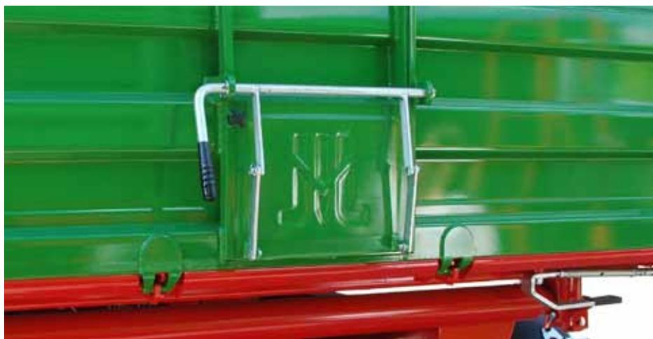
Der Kornschieber wird mit Hilfe zwei Zugvorrichtungen reguliert, was das Auf- und Zumachen erleichtert
