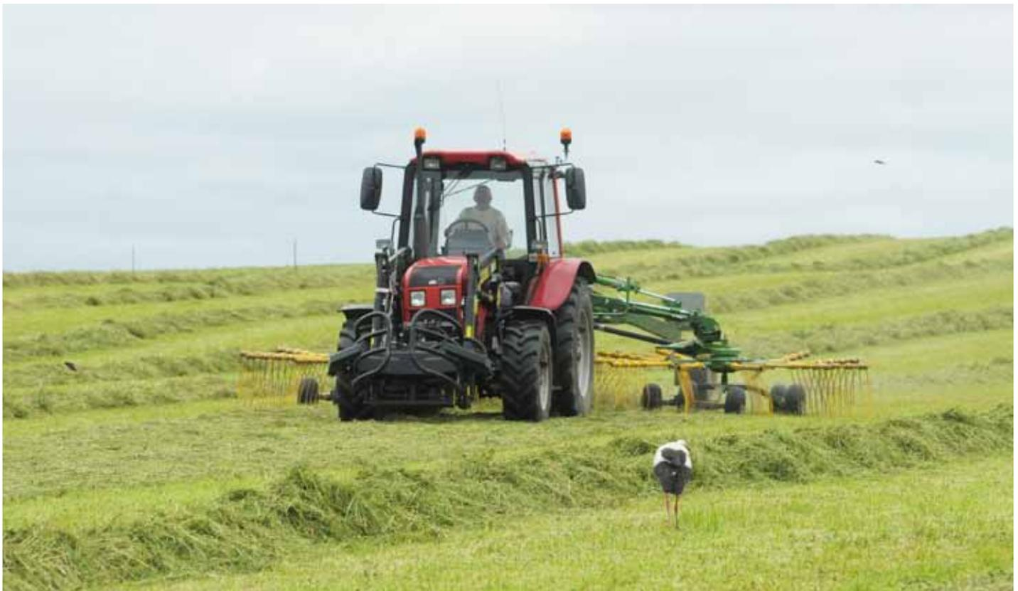
weglichen Kopfes der aktiven Aufhängung des Kreiselchwaders wurde die Wendigkeit und die Geländeanpassung deutlich gesteigert. Zwei Schwingungsdämpfer verbessern den Arbeitskomfort und vereinfachen die zentrale Ausrichtung der Maschine hinter dem Schlepper. Das Fahrwerk wurde mit vier Lufträdern in Tandemanordnung ausgestattet. Die benötigte Leistung des Kreiselschwaders beträgt 22 kW (30 PS)
