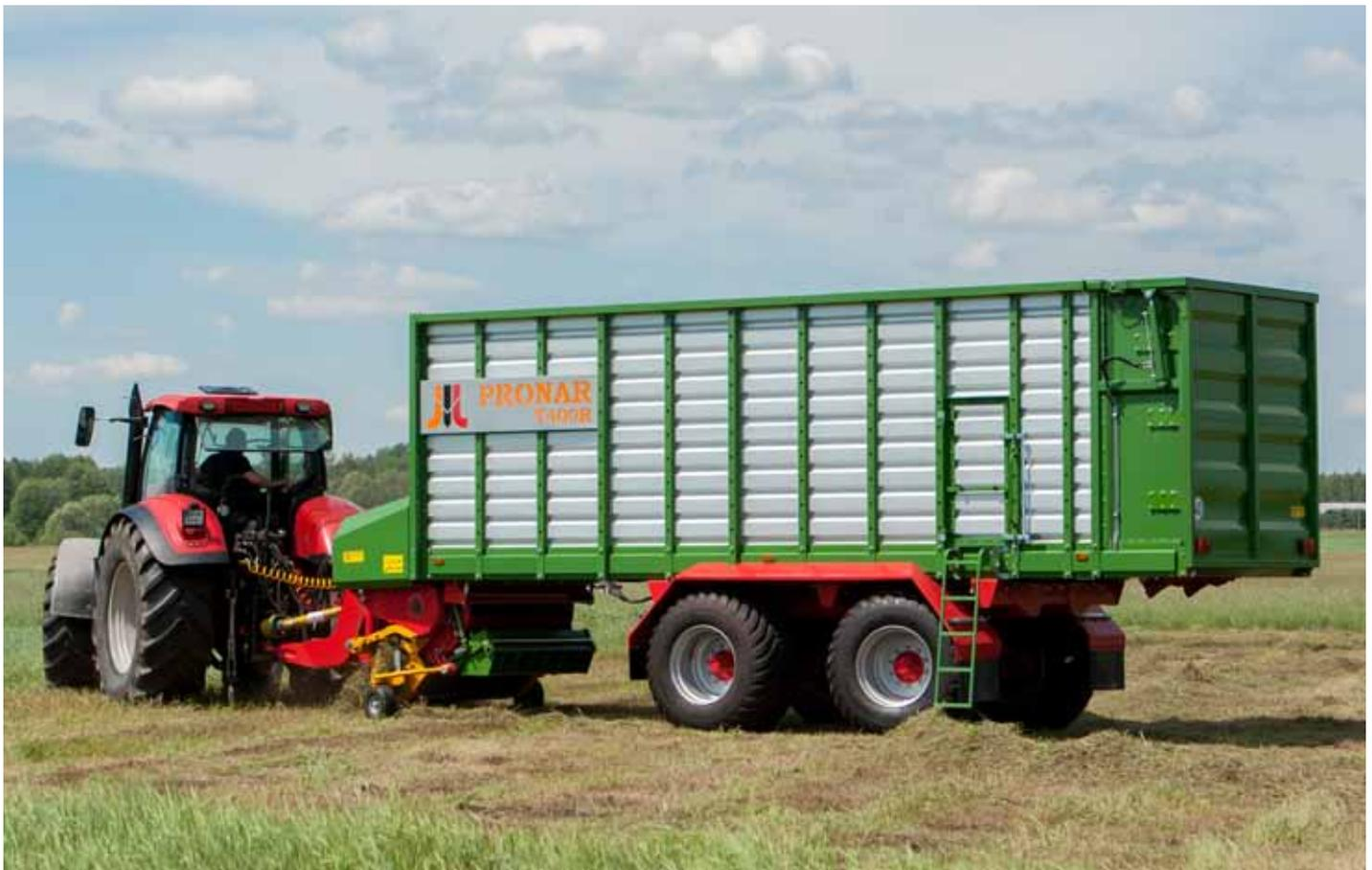
Die Flotation Reifen bewirken auch, dass der fruchtbarer Boden noch mehr geschont wird
